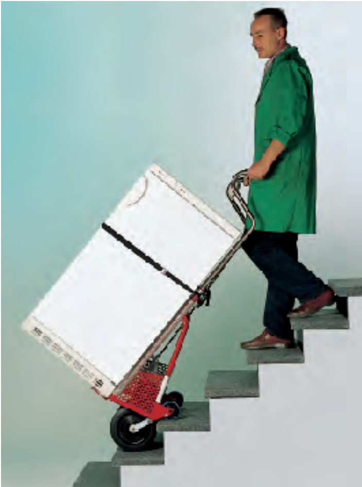
Uittrekbaar: Een hoog transportgoed heeft op de uitgetrokken grepen een veilig steunvlak.
